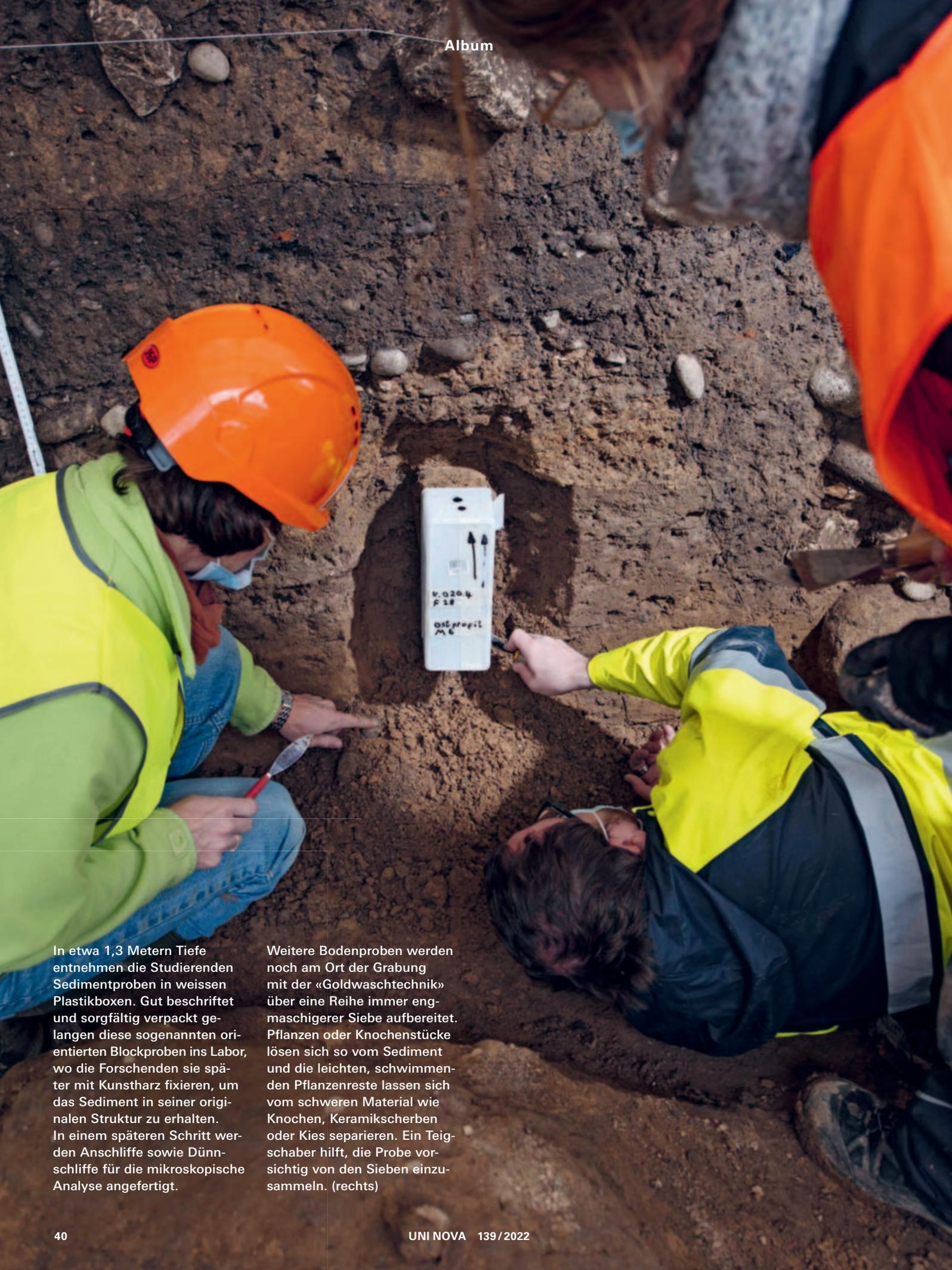
In etwa 1,3 Metern Tiefe entnehmen die Studierenden Sedimentproben in weissen Plastikboxen. Gut beschriftet und sorgfältig verpackt gelangen diese sogenannten orientierten Blockproben ins Labor, wo die Forschenden sie später mit Kunstharz fixieren, um das Sediment in seiner originalen Struktur zu erhalten. In einem späteren Schritt werden Anschliffe sowie Dünnschliffe für die mikroskopische Analyse angefertigt.
