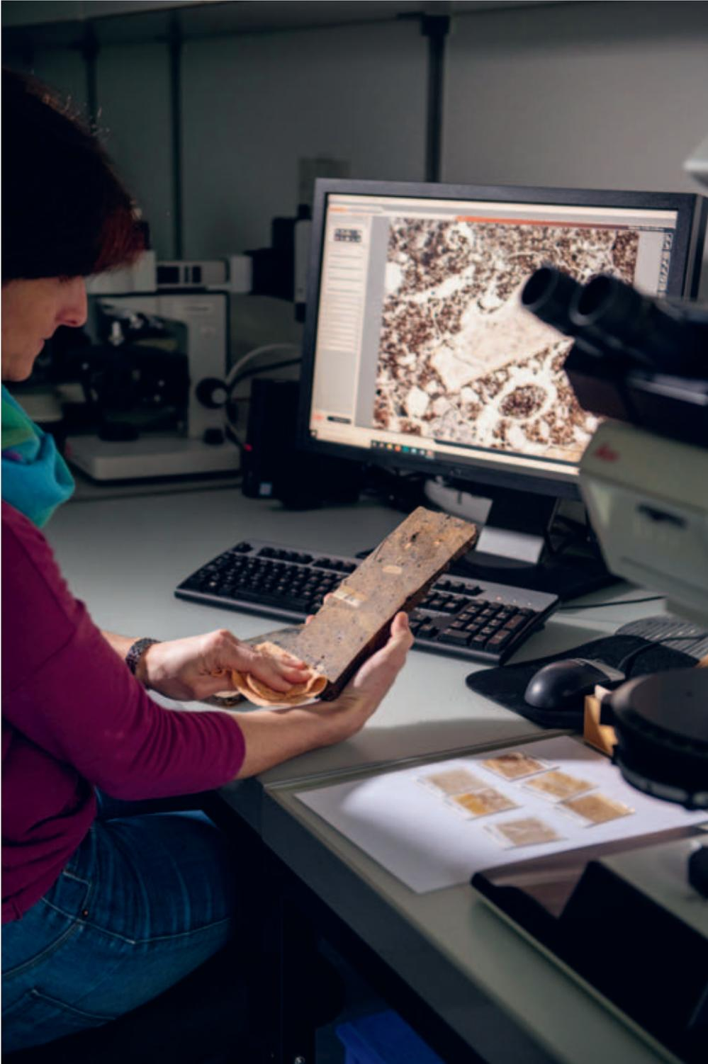
Am Institut studieren die Forschenden Dünnschliffe der gehärteten Blockproben unter dem Mikroskop. Struktur und Zusammensetzung der Ablagerungen geben beispielsweise Einblick in Ereignisse wie Brände, die Vindonissa heimgesucht haben, aber auch weniger Dramatisches wie beispielsweise die Verfüllungen von Gruben oder Latrinen oder die Benutzung von Lehmböden in einem Haus. (links)
