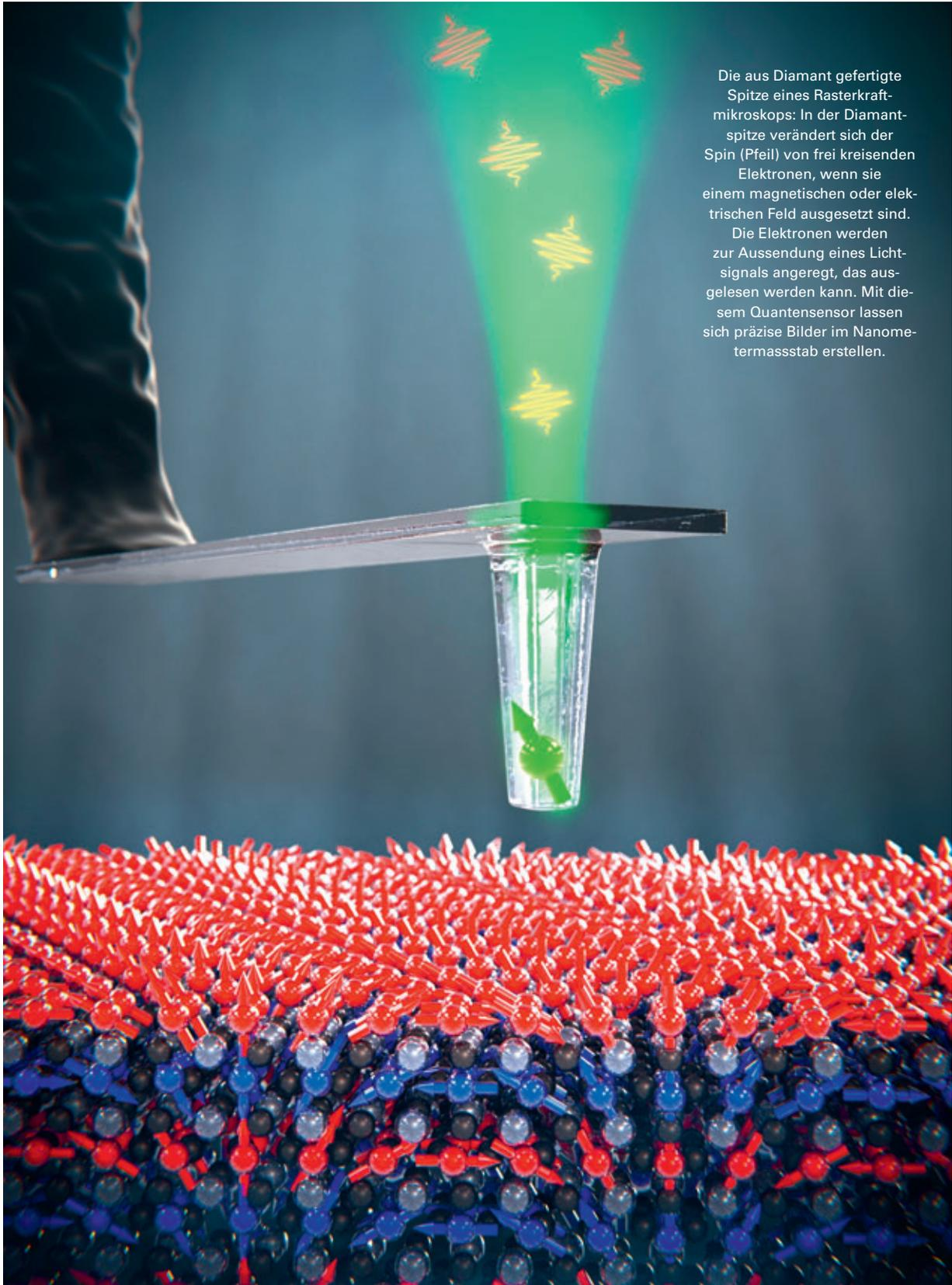
Die aus Diamant gefertigte Spitze eines Rasterkraftmikroskops: In der Diamantspitze verändert sich der Spin (Pfeil) von frei kreisenden Elektronen, wenn sie einem magnetischen oder elektrischen Feld ausgesetzt sind. Die Elektronen werden zur Aussendung eines Lichtsignals angeregt, das ausgelesen werden kann. Mit diesem Quantensensor lassen sich präzise Bilder im Nanometermassstab erstellen.
