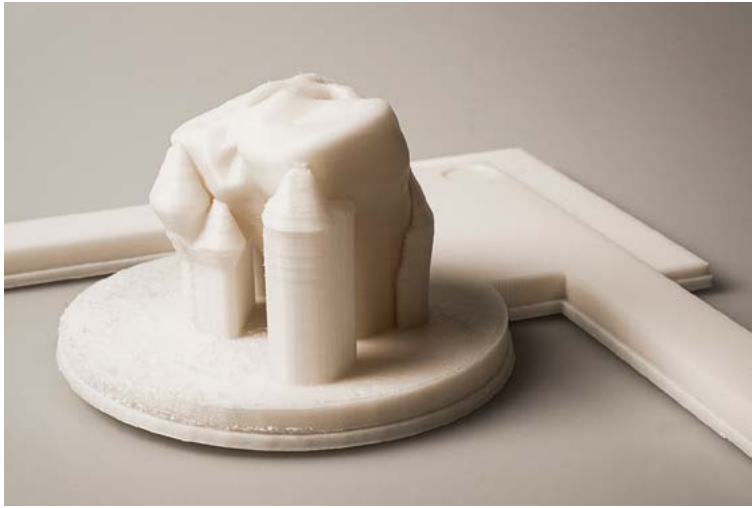
07/08: 3D-Druck eines Kniegelenks. Forscher der ersten Projektphase kalibrieren damit ihren minimalinvasiven Roboter. Fotos: Universität Basel, R. Wendler
